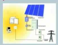
Kernstück der Fotovoltaikanlage sind die Solarmodule, die durch einfallendes Licht Gleichstrom erzeugen. Übrigens nicht nur bei direkter Sonneneinstrahlung, sondern auch bei bewölktem Himmel. Der erzeugte Gleichstrom wird zu Wechselstrom umgewandelt und ins öffentliche Stromnetz eingespeist.
